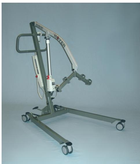
Durch ein Pedal lässt sich das niedrige Fahrgestell bequem spreizen. Das Pedal rastet in den Endpositionen ein, ein versehentliches Öffnen des Fahrgestells während der Fahrt wird zuverlässig verhindert.
